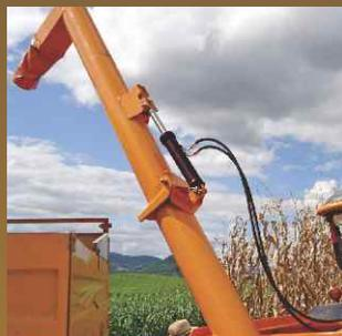
**Sistema de Acionamento da Bica de Descarga:**
